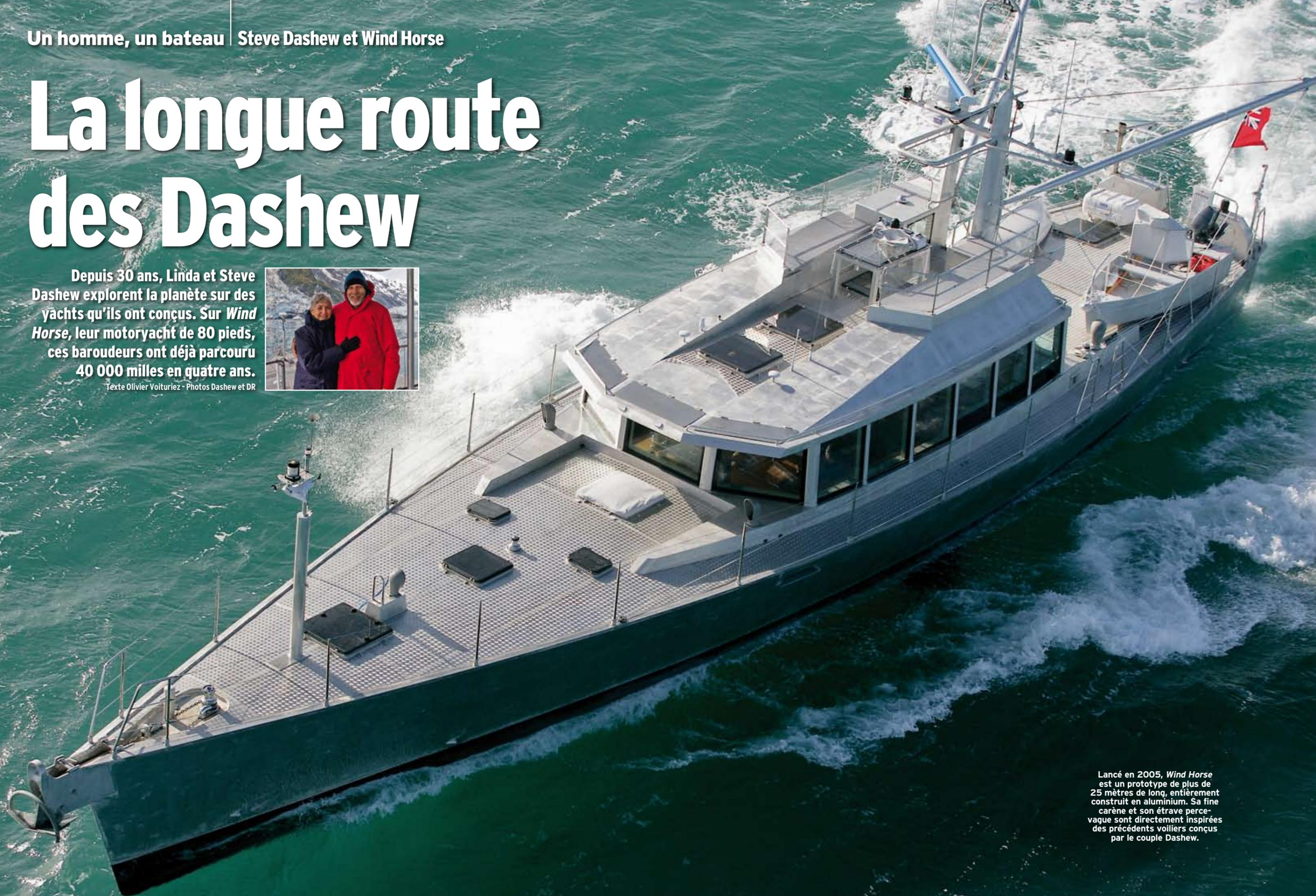
Lancé en 2005, *Wind Horse* est un prototype de plus de 25 mètres de long, entièrement construit en aluminium. Sa fine carène et son étrave percée-vague sont directement inspirées des précédents voiliers conçus par le couple Dashew.
