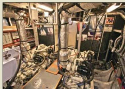
Les deux moteurs de 125 ch John Deere trônent dans une salle des machines à la propreté exemplaire.
